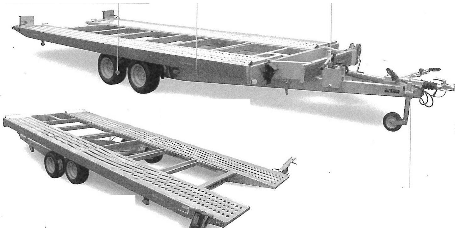
Chassis renforcé mécano soudé et galvanisé à chaud
